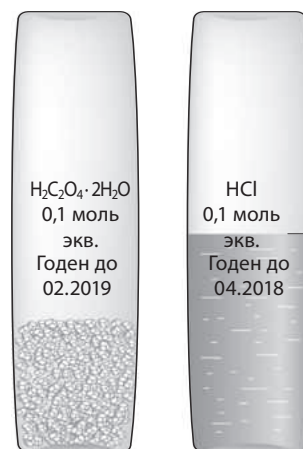
Рис. 7.7. Стеклянная ампула, содержащая определенное количество вещества титранта (фиксанал)
