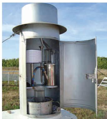
Рис. 62. Плювиометр (осадкомер)
