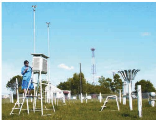
**Рис. 54.** Будка для термометра
