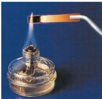
Рис. 2.3. Образование оксида меди (II) (черного цвета) при прокаливании меди в кислороде воздуха
