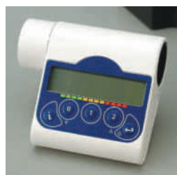
Рис. 3.16. Спирометр – аппарат для измерения объема вдыхаемого воздуха в легких
