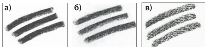
Рис. 1.2. Линии, проведённые на различных видах бумаги: а) тонкой; б) средней тонкости; в) шероховатой
