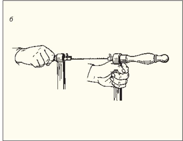
Рис. 1.44. Способы закрепления пилки лобзика:
