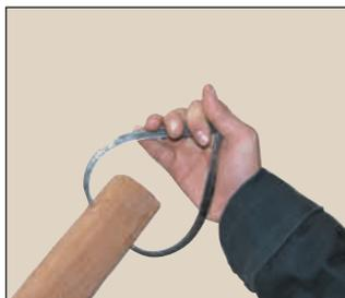
Рис. 1.19. Измерение внешних размеров круглой детали
