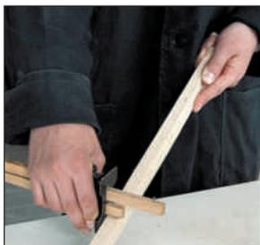
Рис. 1.18. Проведение параллельных линий рейсмусом
