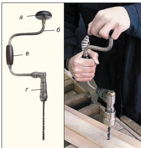
Рис. 1.25. Коловорот и операция сверления отверстия:
