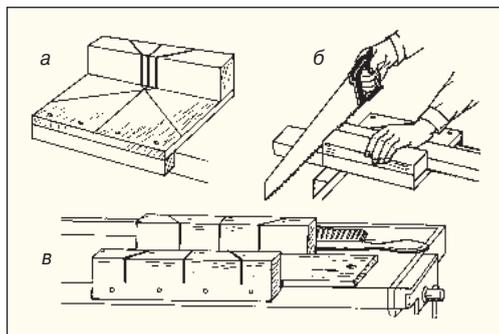
зажимах закрепляется пила, зубья которой должны быть направлены к ручке. Во время работы лобзиком в качестве опоры используются дощечка толщиной 15-20 мм и устройство для зажима, с помощью которого доска укрепляется на рабочем верстаке (рис. 1.24).
