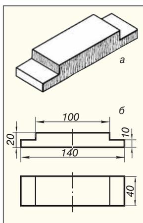
Рис. 1.13. Технический рисунок (а) и эскиз (б) изделия
