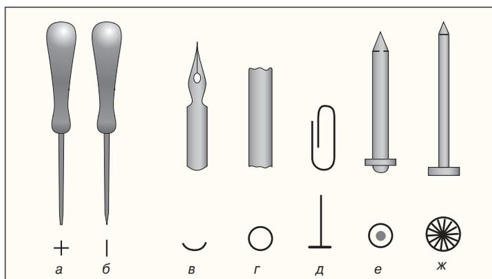
Рис. 1.37. Предметы, которые можно использовать в качестве штампов: *а* — отвёртка «плюс» (+); *б* — отвёртка «минус» (—); *в* — перо; *г* — металлический стержень ручки; *д* — скрепка; *е* — дюбель; *ж* — гвоздь.
