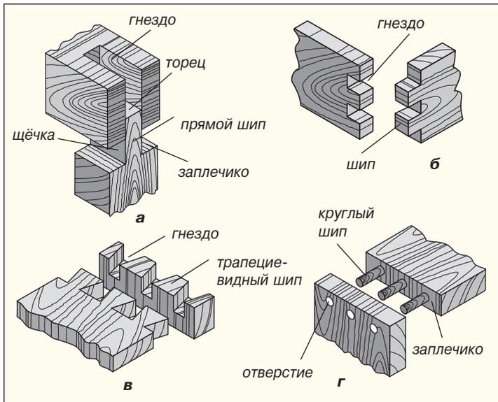
Рис. 1.9. Виды соединений шипами:
