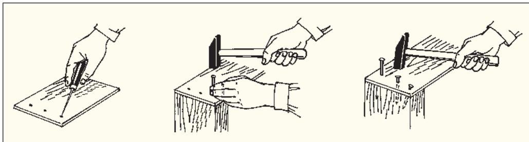
Рис. 1.29. Соединение гвоздями
