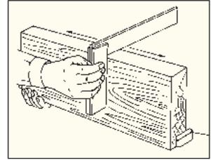
Рис. 1.6. Проверка качества обструганных поверхностей при помощи угольника
