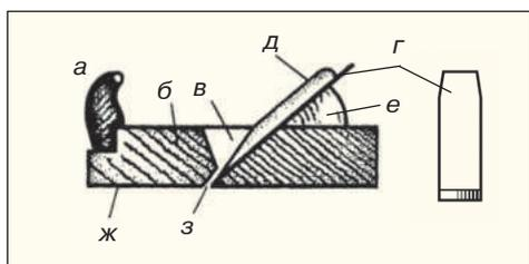
Рис. 1.2. Строение рубанка: а — ро́г, б — корпус, в — леток, г — клин, д — нож, е — вставка крепления, ж — подошва, з — пролёт
