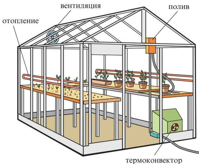
Рис. 9.8. Конструкция теплицы
