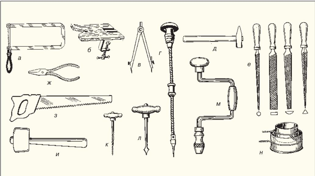
*Рис. 1.40.* Инструменты для художественного выпиливания по дереву: *а* — лобзик; *б* — станок для выпиливания; *в* — циркуль; *г* — дрель; *д* — маленький молоток; *е* — надфили; *ж* — плоскогубцы; *з* — мелкозубая ножовка; *и* — киянка; *к* — буров; *л* — шило с плоским концом; *м* — коловорт; *н* — клеанка
