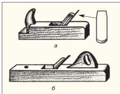
Рис. 1.3. Рубанки: а — шерхебель; б — полуфуганок
