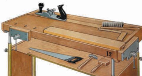
Рис. 1.9. Размещение инструментов на столярном верстаке
