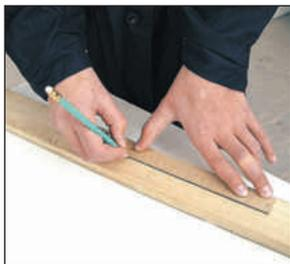
Рис. 1.16. Проведение линии с помощью линейки
