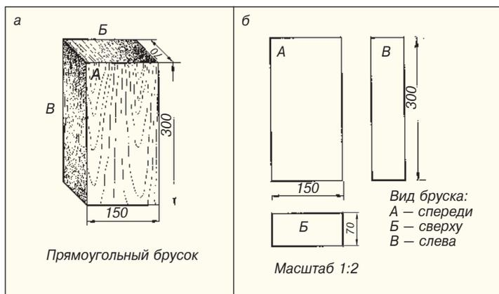
Рис. 1.12. Технический рисунок (а) и чертёж бруска (б)
