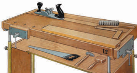
Рис. 1.9. Размещение инструментов на столярном верстаке
