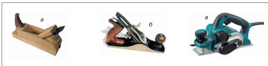
Рис. 1.1. Рубанки: а — с деревянным корпусом; б — с металлическим корпусом, в — электрический
