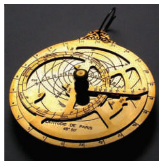
Рис. 1.18. Астрольбия – прибор для определения положения звезд относительно горизонта
