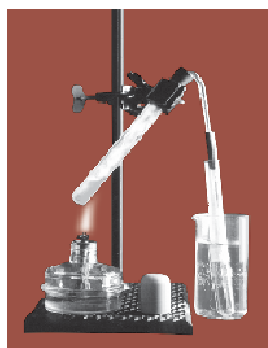
Рис. 3.6. Дистилляция (перегонка) воды в простейшем приборе
