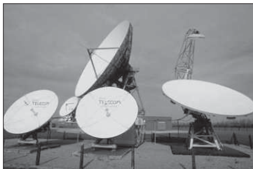
Наземные ретрансляционные станции, образующие радиолинии
