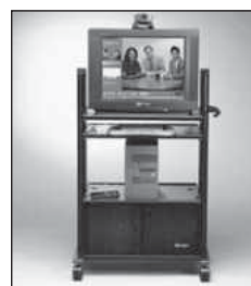
Цифровая видеокамера (сверху экрана) Цифровое изображение обрабатывается компьютером и выводится на экран
