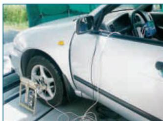
**Рис. 12.11.** Проверка люфта рулевого колеса
