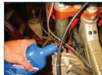
Рис. 12.9. Дополнение уровня жидкости в радиаторе антифризом
