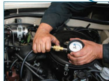
Рис. 12.7. Проверка компрессии в цилиндрах
