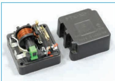
**Рис. 11.16.** Пускозащитное реле холодильника
