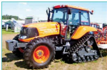
Рис. 13.5. Полугусеничный трактор
