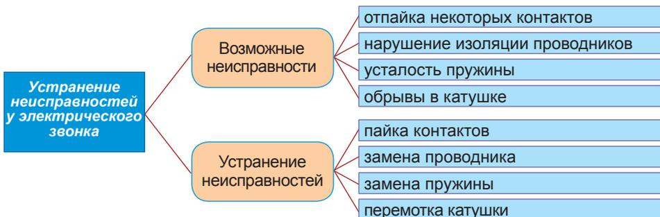
**Схема 11.1.** Устранение возможных неисправностей у электрического звонка
