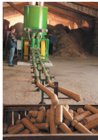
Рис. 3.44. Производство топлива из биомассы
