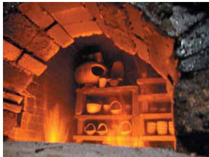
Печь для обжига (термической обработки) керамики
